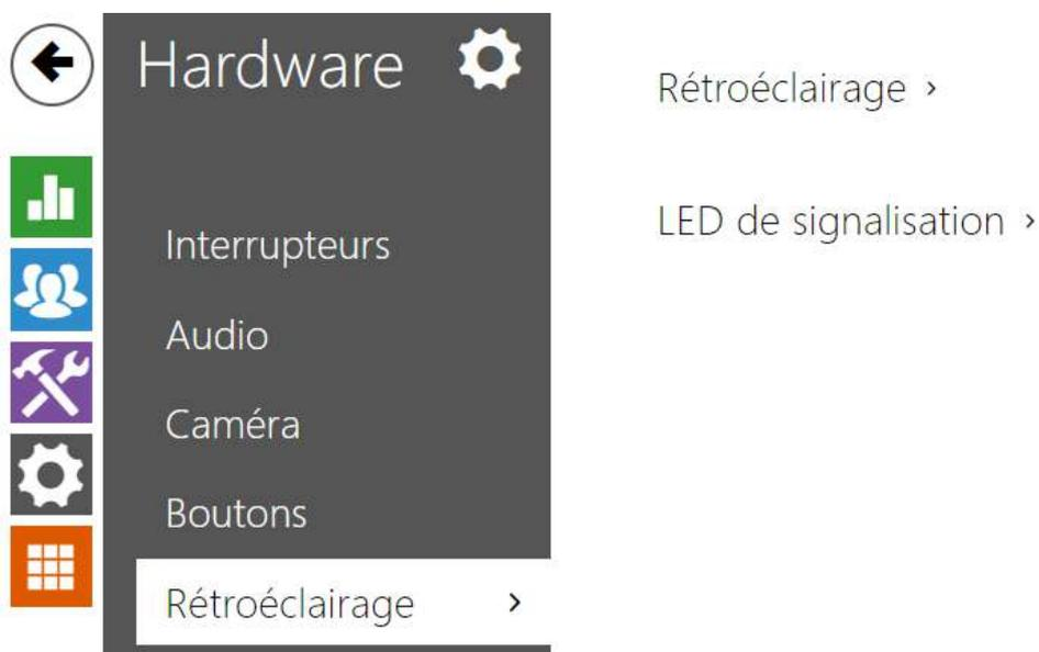
Cette section vous permet de contrôler le niveau de rétroéclairage des étiquettes d'identification, des boutons et la luminosité des voyants de signalisation.
