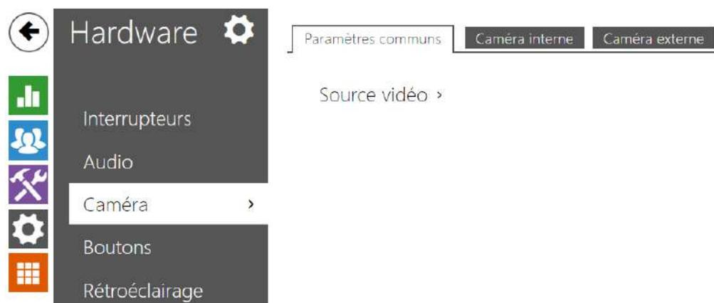
Este menú está disponible solo en los **intercomunicadores 2N IP** que están equipados con la cámara interna o permiten conectar una cámara externa. La señal de la cámara se puede transmitir directamente a la llamada al videoteléfono, enviar mediante e-mails, transmitir mediante el protocolo ONVIF/RTSP a otro dispositivo (por ej. vídeo surveillance) o descargar fácilmente desde el intercomunicador como imágenes JPEG mediante el protocolo HTTP.
