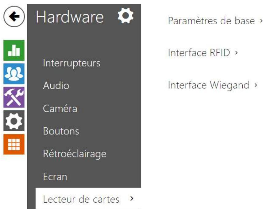
Cette onglet est disponible sur les modèle **2N® IP Base**, **2N® IP Vario** et **2N® IP Force**. Sur le modèle **2N® IP Verso** seule l'option permettant de limiter les tentatives d'accès infructueuses est configurée ici. Les autres options de lecteur de carte seront configurées dans le menu **Extendeurs**.
