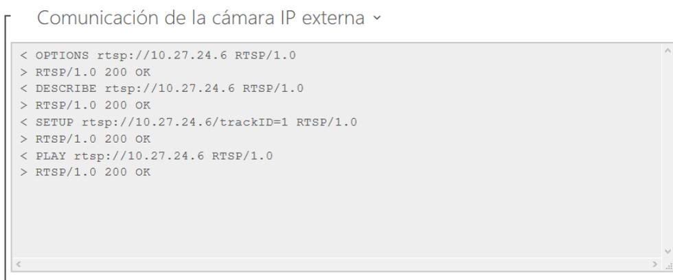
En la ventana Comunicación de la cámara IP externa se muestra el transcurso de la comunicación RTSP con la cámara IP externa configurada, incluidos los posibles errores y estados de fallo.
