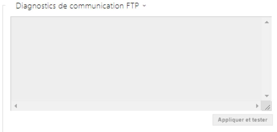
Cliquez sur **Appliquer et tester** pour enregistrer la configuration actuelle du serveur FTP, charger l'image de la caméra et enregistrer l'image sur le serveur FTP. La fenêtre ci-dessus affiche les détails de la communication avec le serveur FTP lors de la sauvegarde.
