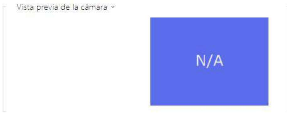
En la ventana Vista previa de la cámara se muestra la imagen actual recibido de la cámara externa. En el caso de que la cámara externa no esté conectada o configurada correctamente, aparecen símbolos N/A sobre un fondo azul.
