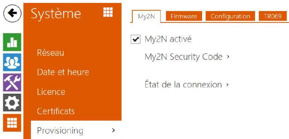
Les **interphones IP 2N** vous permettent de mettre à jour le firmware et la configuration manuellement ou automatiquement à partir d'un stockage sur un serveur TFTP / HTTP que vous avez sélectionné selon des règles prédéfinies.
