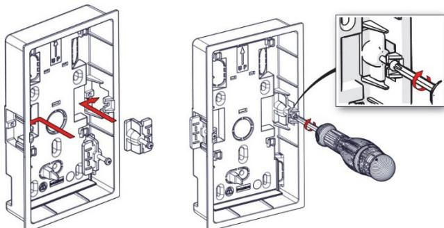
Inserte un tornillo en cada pestaña y coloque una tuerca al final de cada tornillo. Coloque las dos pestanas en sus ranuras y fije dos tornillos, tal y como se muestra.
