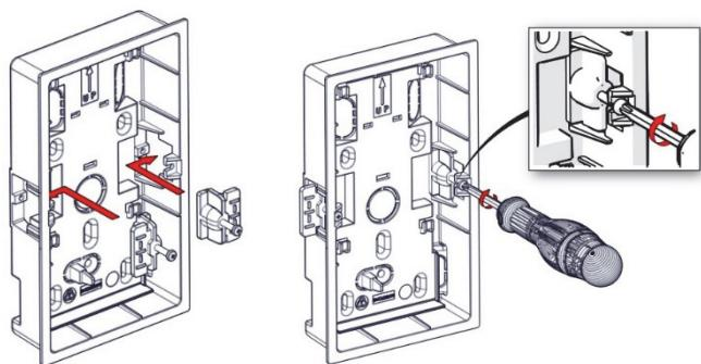
Plaats een schroef in elke vergrendelbeugel en montere een moer op het einde van elke schroef.
