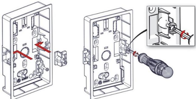
Inserire una vite in ogni linguetta plastica e avvitare il dado alla fine di ognuna delle due viti. Posizionare le due linguette nei loro alloggiamenti e fissarle con le due viti come mostrato
