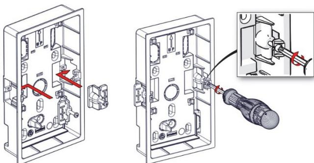
Insérez une vis dans chaque attache et fixez un écrou à l'extrémité. Insérez les deux attaches dans leurs logements et fixez-les à l'aide des vis, comme illustré.
