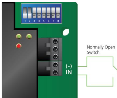
Figuur 9: Normaal Geopende Input Verbinding
