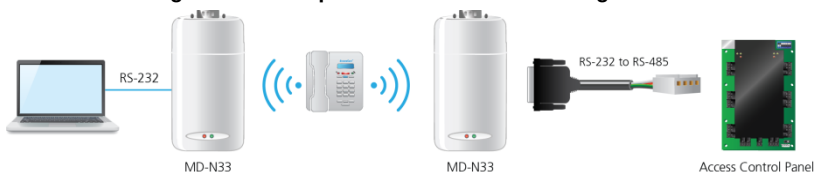
Figuur 21: Site op afstand met modem configuratie
