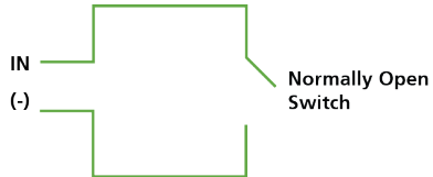
Figuur 10: Normaal Open Input verbinding
