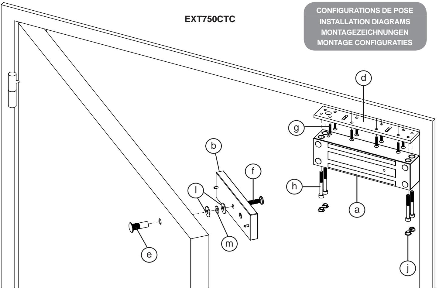
Insérer la rondelle caoutchouc (m) entre les rondelles métalliques (l) en évitant de serrer l'ensemble trop fortement afin de conserver la mobilité de la contreplaque.
