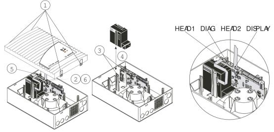
Replacing a detector module
