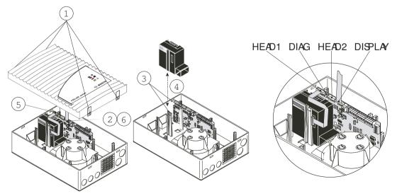
Replacing a detector module
