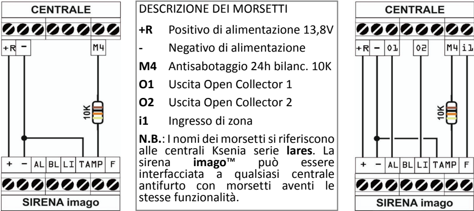
Figura 4. Collegamenti con la centrale
