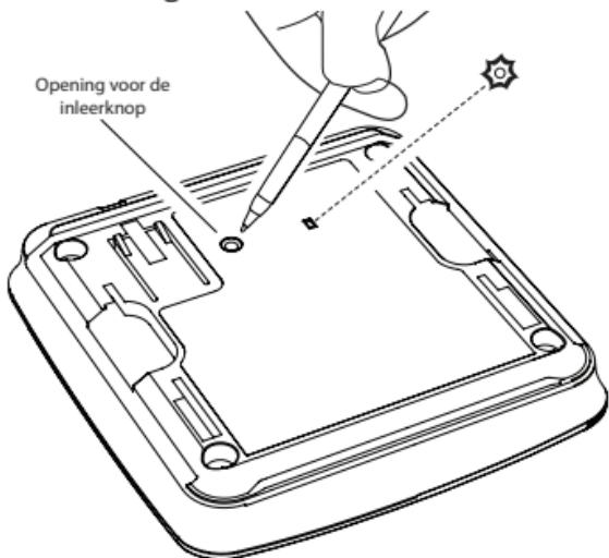
2. Gedurende deze 5 seconden dient u kort de testknop op een melder die al in het netwerk zit in te drukken om draadloos te koppelen. De melder laat een geluid horen, dat bestaat uit 2 series van drie harde piepen.
