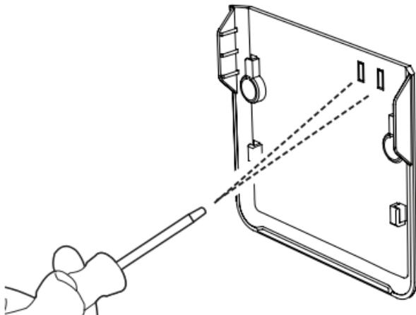
Wenn die übrige Installation abgeschlossen und das Controller Modul auf der Halterung fixiert ist, kann es nur mehr wie folgt entfernt werden:
