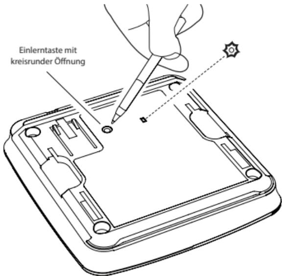
2. In diesen 5 Sekunden müssen Sie kurz die Testtaste eines bereits im Netzwerk befindlichen Melders drücken, um die beiden per Funk zu verbinden. Der Melder gibt ein hörbares Signal aus, das aus zwei Zyklen von jeweils drei lauten Pieptönen besteht.
