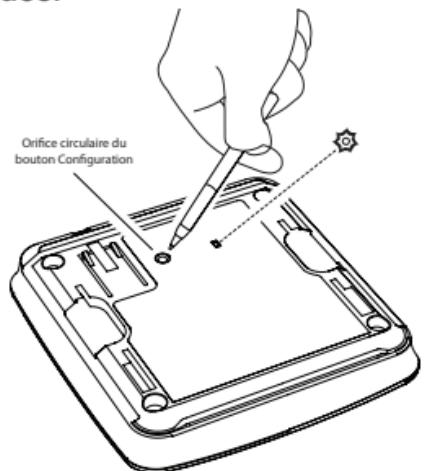
2. Pendant ces cinq secondes, vous devez appuyer brièvement sur le bouton de test d'un des détecteurs faisant partie du réseau afin d'établir la liaison sans fil. Le détecteur émet alors deux séries de trois bips sonores puissants.
