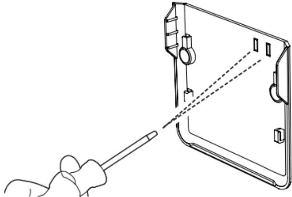
Als de rest van de installatie is afgerond en de locatieschakelaar vastzit op de wandhouder, kan hij alleen verwijderd worden door de volgende methode te gebruiken:
