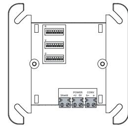
Ligue o módulo Fim de Linha (EOL) de modo a que seja o último elemento numa linha convencional. Defina a resistência (R), a voltagem (V), e a potência (P) da linha através dos interruptores DIP, utilizando o software de programação FSP-5000-RPS para calcular os valores e definições DIP associados.
