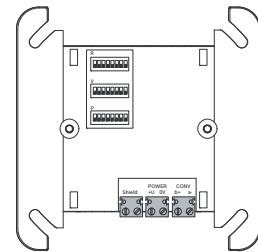
Az EOL-modult utolsó elemként csatlakoztassa a hagyományos vonalhoz. A DIP-kapcsoló segítségével állítsa be a vonal ellenállását (R), feszültségét (V) és teljesítményét (P) a FSP-5000-RPS programozó szoftvert használva az értékek kiszámításához és a társított DIP kapcsolók beállításához.
