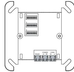
Conecte el módulo de final de línea como el último elemento de una línea convencional. Establezca la resistencia (R), la tensión (V) y la alimentación (P) para la línea mediante los microinterruptores, utilizando el software de programación FSP-5000-RPS para calcular los valores y los ajustes.
