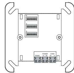
Sluit de afsluitmodule aan als laatste element in een conventionele lijn. Stel de weerstand (R), de spanning (V) en de voeding (P) voor de lijn in via de DIP-switches. Gebruik daarbij de FSP-5000-RPS programmeersoftware om de waarden en overeenkomstige DIP-instellingen te berekenen.
