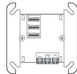
Zakončovací modul připojte jako poslední prvek konvenční linky. Prostřednictvím Programovacího softwaru FSP-5000-RPS vypočtěte hodnoty a příslušná nastavení dvoupolohových mikropřepínačů a nastavte s nimi odpor (R), napětí (V) a napájení (P) linky.
