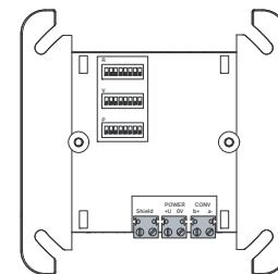
EOL modülünü konvansiyonel hatalara en son eleman olarak bağlayın. DIP anahtarlarını kullanarak hat içi direnç (R), gerilim (V) ve güç (P) değerlerini ayarlayın; değerleri hesaplamak ve ilişkili DIP ayarlarını yapmak için FSP-5000-RPS programlama yazılımını kullanın.
