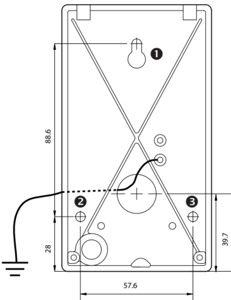
Fig. 1 - Plaque arrière du PP500. Dimensions en mm.
