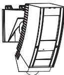
: PIR intelligente combinato con creep zone (campo di rilevamento sotto il rilevatore)
