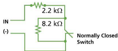
Figuur 7: Normaal gesloten bewaakte ingang met dubbele weerstand
